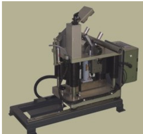
图为：漏磁焊缝检测系统机械台架及探头
