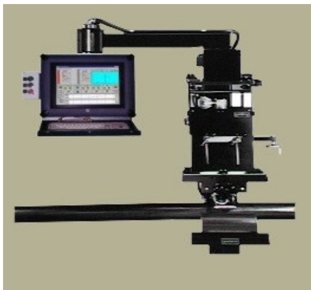
上图为: 直缝焊管焊缝检测示例图
